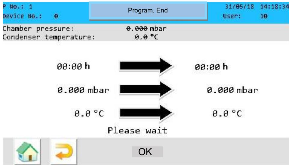
腔室压力将继续调节到最后的设定值。当您按下“确定”按钮时，程序完成并关闭真空泵。您现在可以给冻干仓回填气体。
