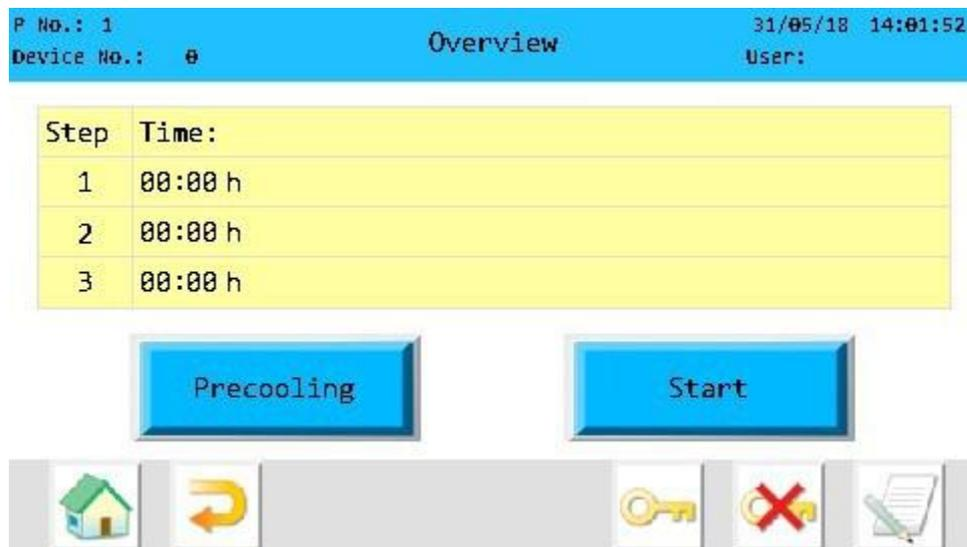
如果按“Pre cool”（预冷却），冷凝器将冻结到温度（ $-50^{\circ}\text{C}$ 或 $-80^{\circ}\text{C}$ ）。此步骤需要10分钟，之后可以开始干燥。在预冷时间到期后，您可以加载样品到冻干仓。
