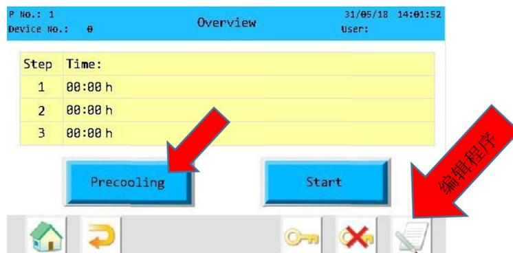
8. 预制冷结束后，从低温冰箱中取出冻干物料（取出时戴防护手套）放置于冻干仓中，确认完全密封后，点击“√”，真空泵开始运行。冷冻干燥程序正式启动（进入 Drying step 1 步骤）。
