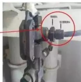
图4 增压阀连接气管路局部
