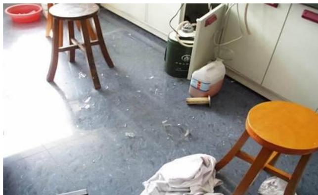
**事故原因：**玻璃封管不耐高压，且在反应过程中无法检测管内压力。氨水在高温下变为氨气和水蒸气，产生较大的压力，致使玻璃封管爆炸。
