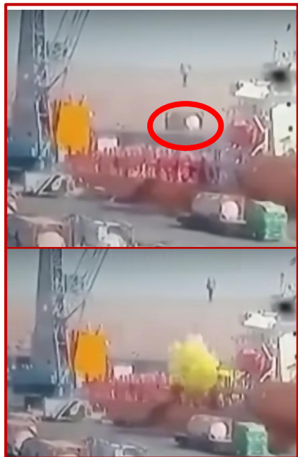
图1. 吊运液氯罐箱时吊索断裂
