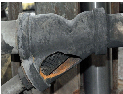
图2. 过滤器上的一个大孔，因压力过大发生脆性断裂。
