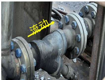
图2. 过滤器上的一个大孔，因压力过大发生脆性断裂。
